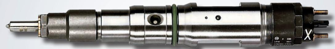
Восстановленная форсунка топливной системы
